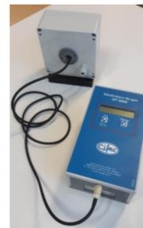
Générateur de chlore portable pour le calibrage d'une cellule
