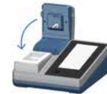
Fermer le couvercle. La mesure démarre automatiquement.
